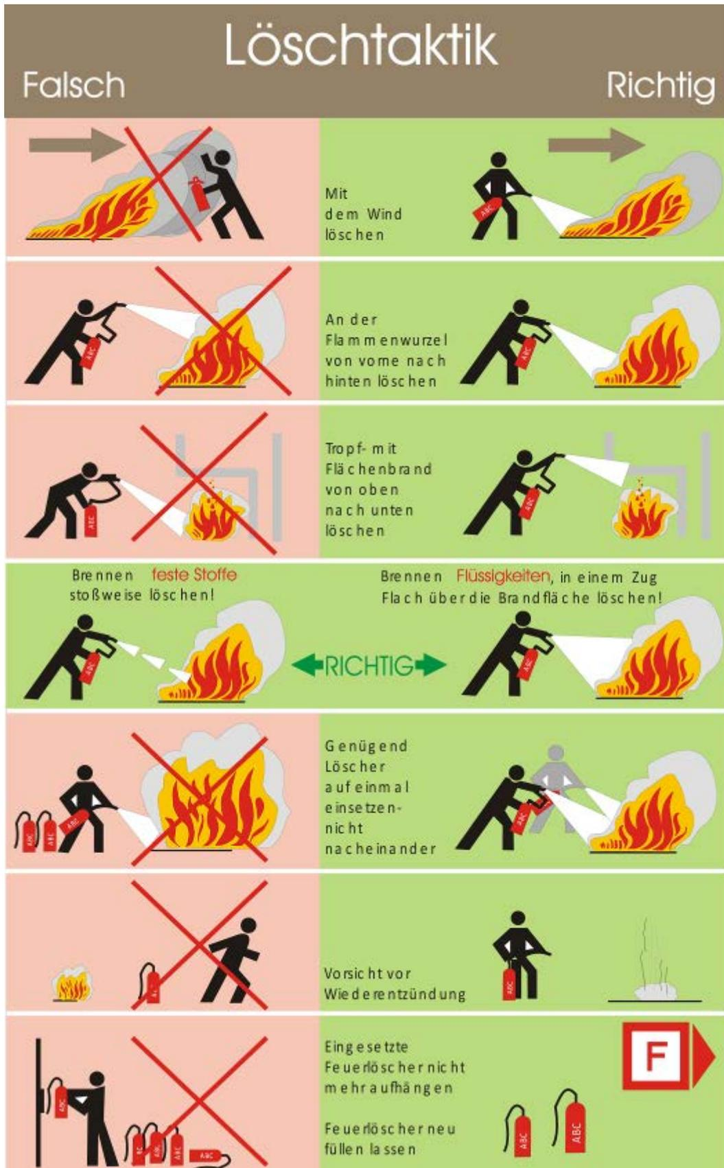
Abb. 35: Darstellung Löschtaktik mit Feuerlöscher
