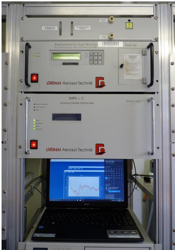
Abbildung 18: UFP-Messgerät in der stationären Luftgütemessstation der FBB
