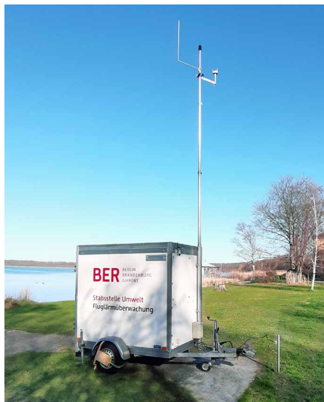
An wechselnden Standorten führt die FBB mobile Messungen durch, an denen die Fluglärmereignisse in der Regel über einen Monat aufgezeichnet werden.
