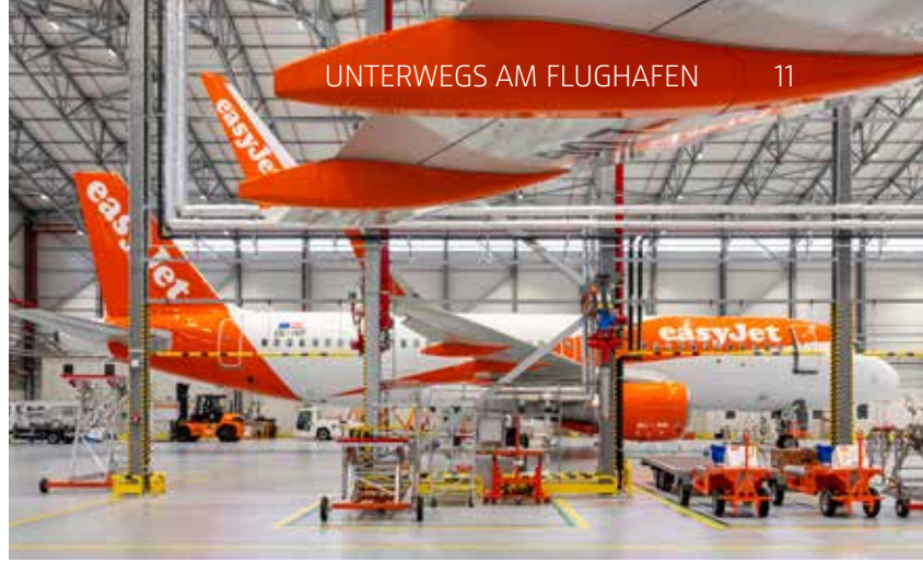
Im easyJet-Hangar am BER können bis zu vier Flugzeuge der Airbus-A320-Familie gleichzeitig gewartet werden.
