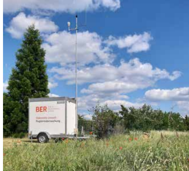
Zwei solche mobile Messstellen betreibt die Flughafengesellschaft (neben derzeit 31 stationären Messstellen), um den Fluglärm rund um den BER zu überwachen. Die mobilen Messungen finden an monatlich wechselnden Standorten statt.
